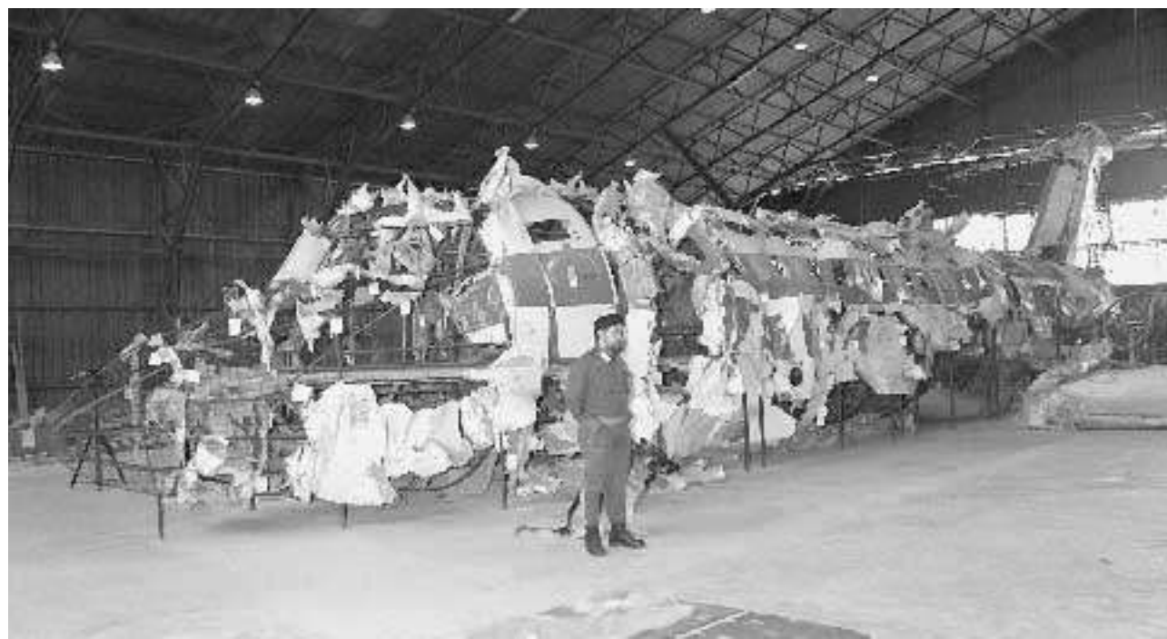
Il relitto del Dc9 Itavia di Ustica ricostruito nell'hangar di Pratica di Mare
